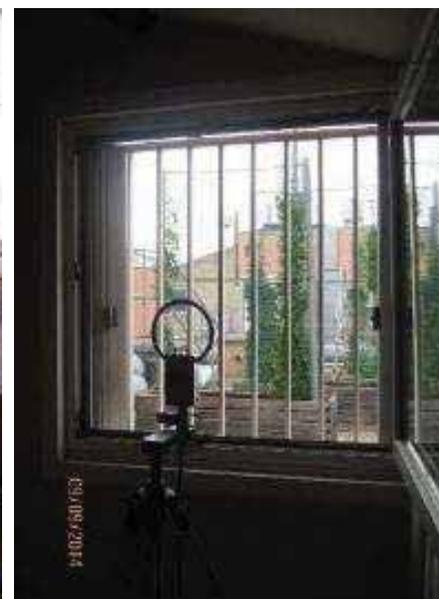
*Appareils de mesure des champs électromagnétiques*
