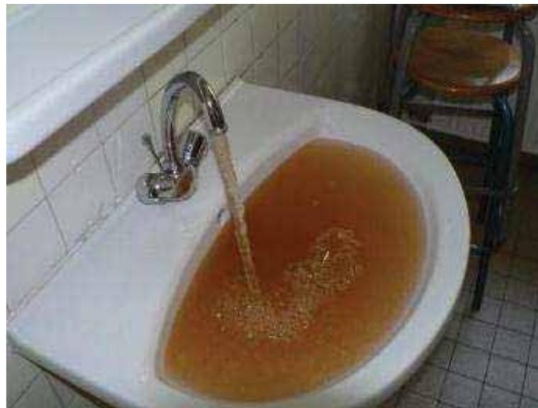
*Eau colorée par des canalisations en fer galva corrodées, devenant impropre à la consommation.*
