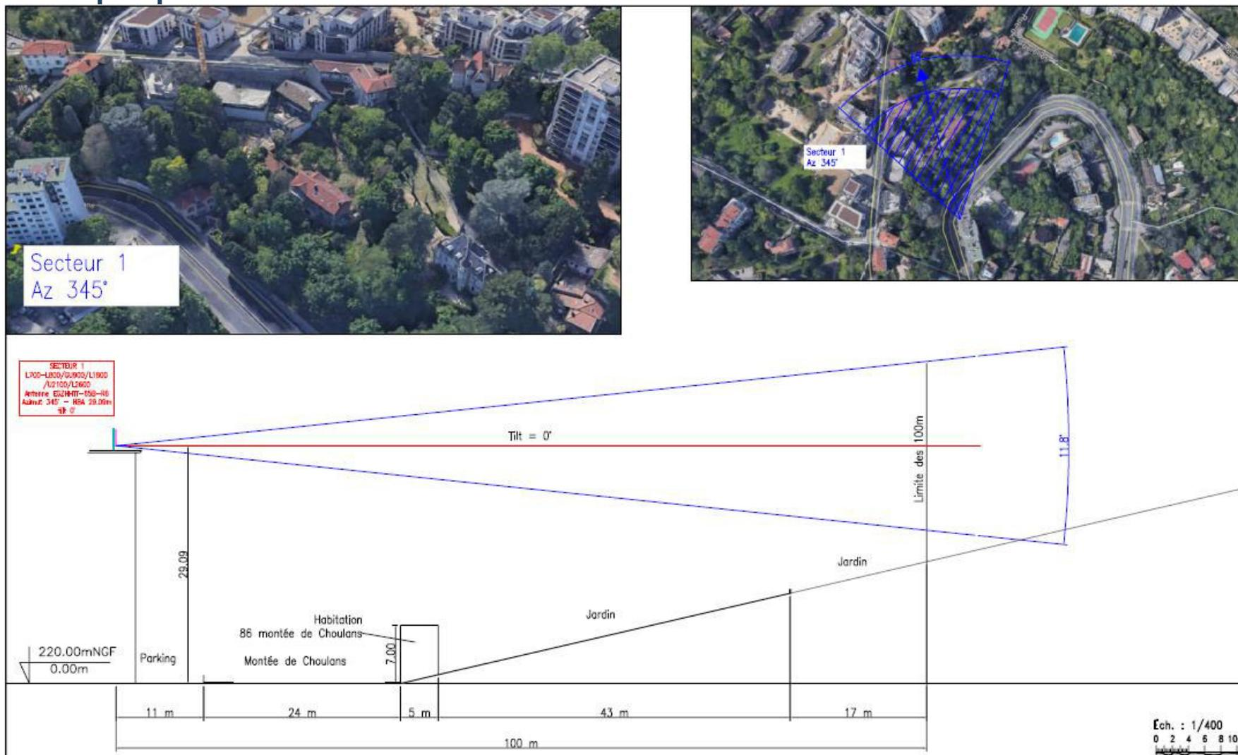
Les antennes à faisceaux orientables n'ont pas de direction privilégiée de rayonnement. Une station relai composée de 3 secteurs couvre horizontalement sur 360°.
