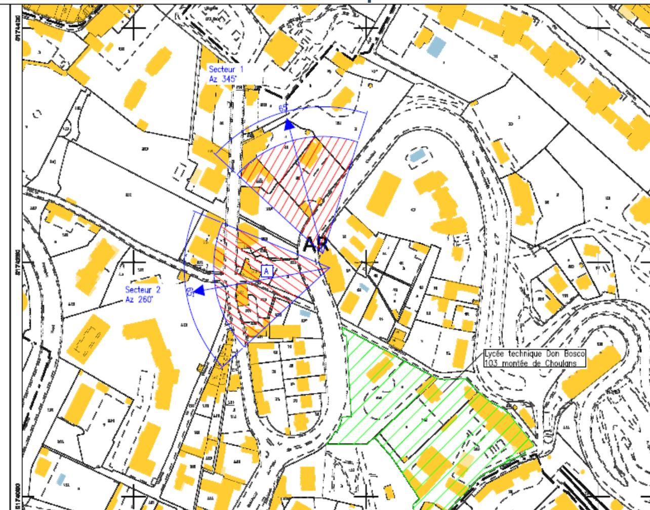
Les antennes à faisceaux orientables n'ont pas de direction privilégiée de rayonnement. Une station relai composée de 3 secteurs couvre horizontalement sur 360°.
