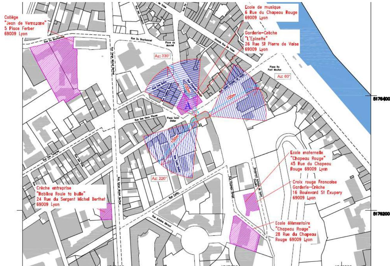
PLAN DES AZIMUTS DES ANTENNES AVEC LOCALISATION DES ESTIMATIONS DONNEES
