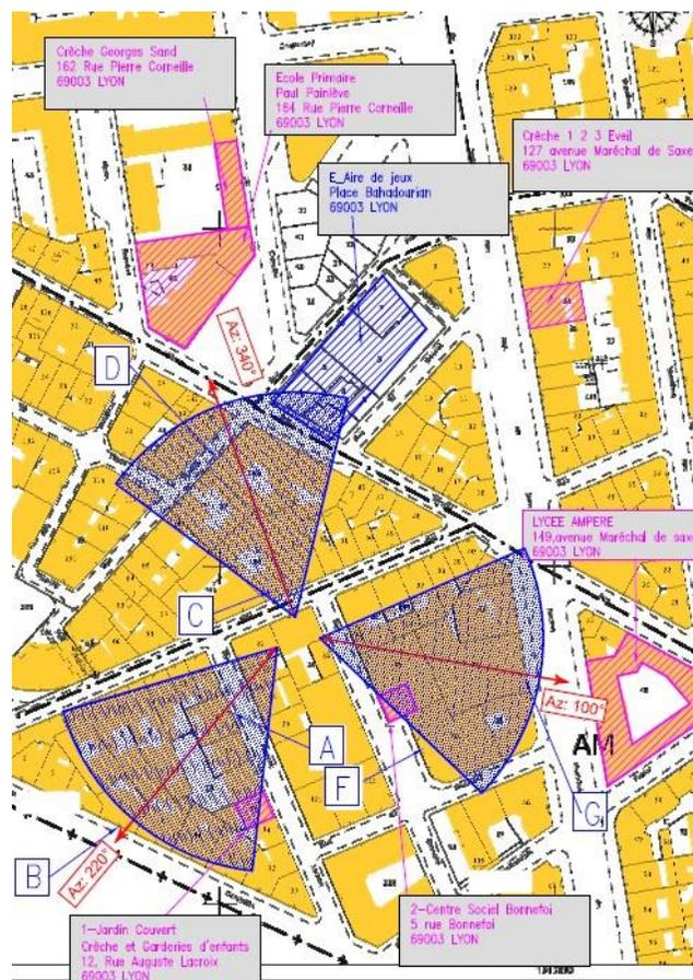
**PLAN DES AZIMUTS DES ANTENNES AVEC LOCALISATION DES ESTIMATIONS DONNEES**
