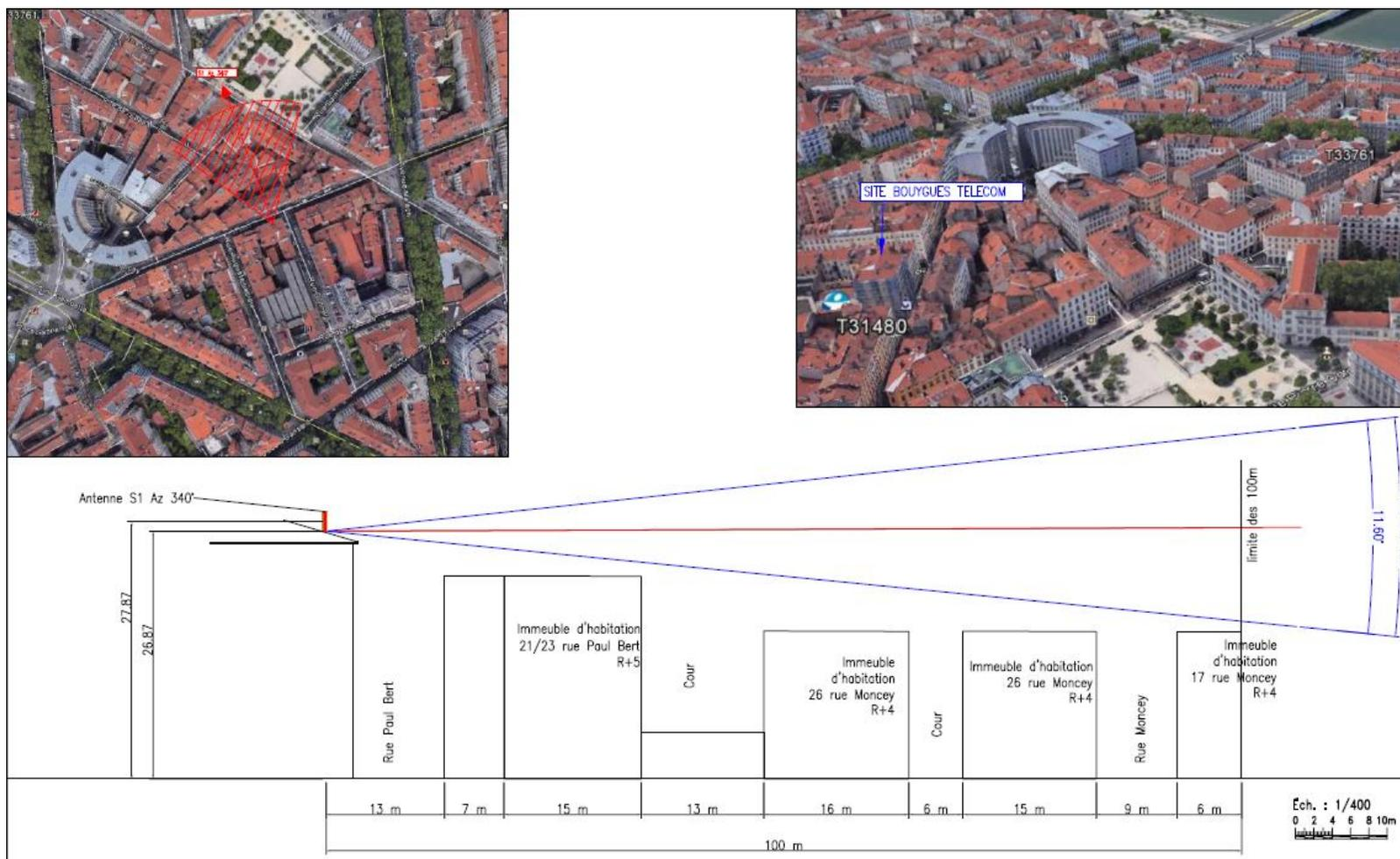
Les antennes à faisceaux orientables n'ont pas de direction privilégiée de rayonnement. Le cône ci-dessus, habituellement représenté pour les antennes à faisceaux fixes, n'est pas représenté pour ces dernières car il n'est pas applicable pour cette technologie antennaire qui n'émet pas de façon constante dans une ouverture angulaire donnée.
