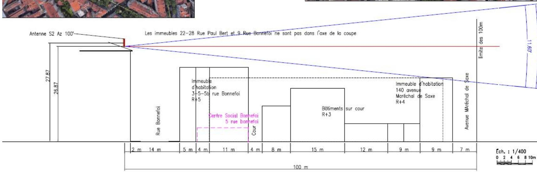
Les antennes à faisceaux orientables n'ont pas de direction privilégiée de rayonnement. Le cône ci-dessus, habituellement représenté pour les antennes à faisceaux fixes, n'est pas représenté pour ces dernières car il n'est pas applicable pour cette technologie antennaire qui n'émet pas de façon constante dans une ouverture angulaire donnée.
